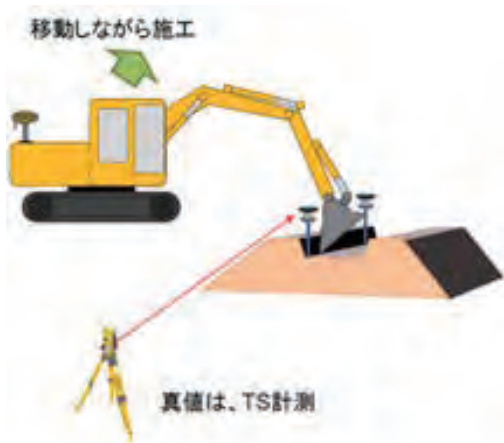
図-5 整形作業での精度検証方法
