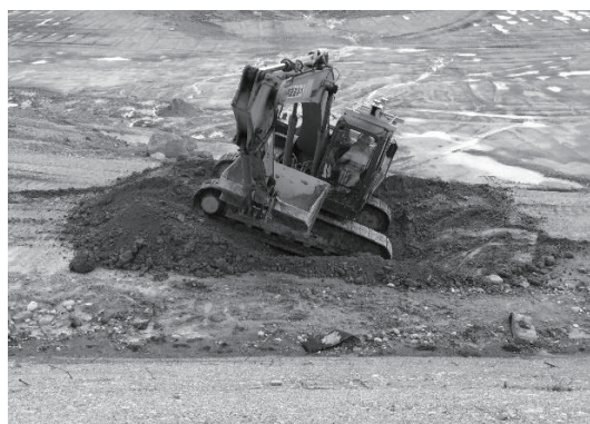
写真-2 重機 LS 傾斜時の計測試験
