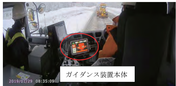
写真-7 ガイダンス装置本体車載例
