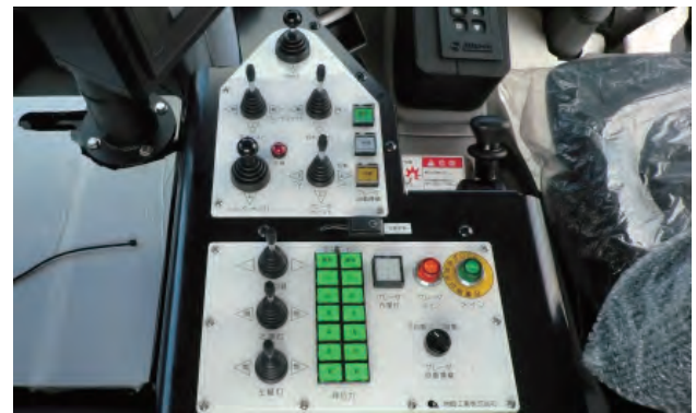
写真-8 除雪トラックの作業装置操作レバー
