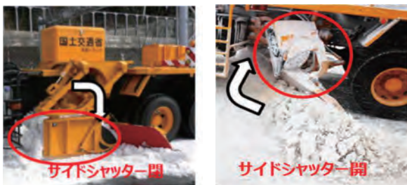
写真-10 サイドシャッタ動作状況
