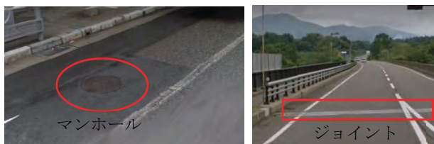
写真-2 進行方向のガイダンス対象 1 障害物
