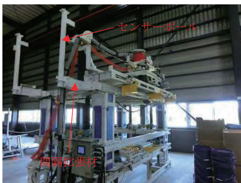
写真-15 改良後接触センサーポール
