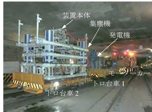
写真-5 研掃装置の車両編成 (地下鉄)
