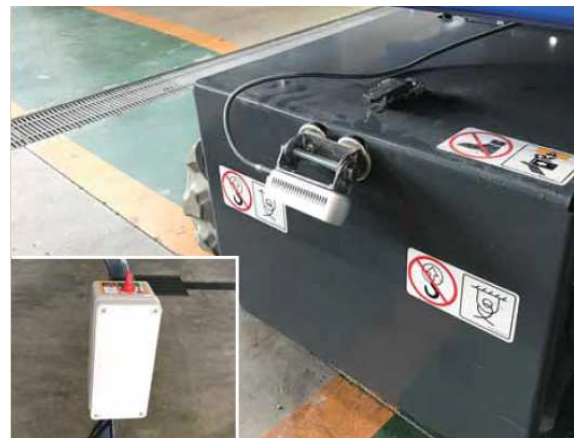
写真-3 (バックダンサ設置状況)
