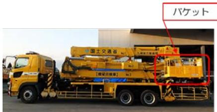
写真-1 橋梁点検車 (型式BT400)
