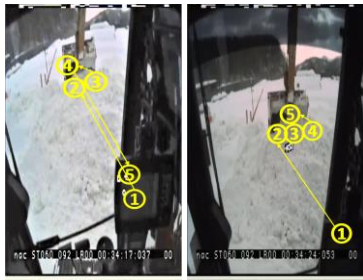
図-6 未熟オペレータの作業確認点
