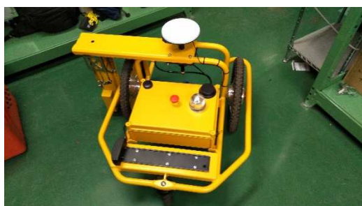
写真-2 自動描写する自動走行ロボット
