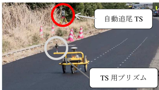
写真-4 自動追尾 TS 併用例
