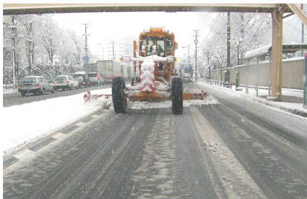
写真－1 従来型VB 作業状況（伸ばした状態(L=6m)）
