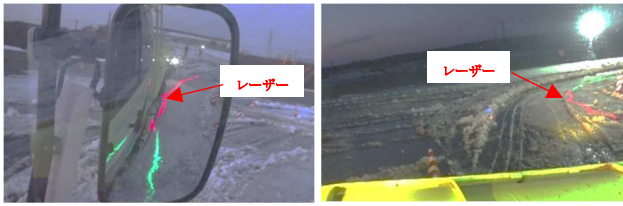
写真-6 レーザー試験の除雪走行状況
