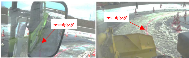
写真-5 マーキング試験の除雪走行状況
