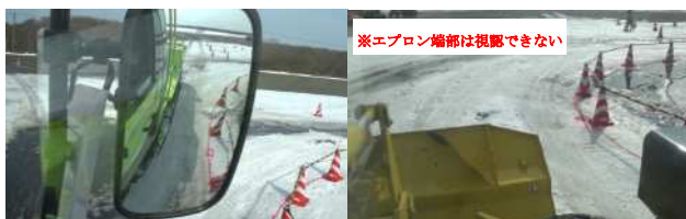
写真-4 無対策試験の除雪走行状況
