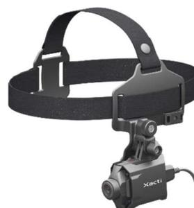
図-3 遠隔現場巡回専用ウェアラブルデバイス本体
