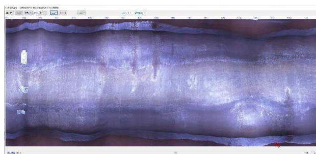
写真-5 画像展開ソフトによる展開画像の例 (左端の断面が写真-4の位置)
