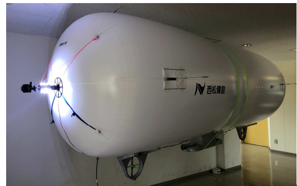
写真-1 水路トンネル調査ロボット
