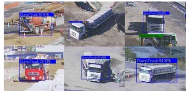
図-7 建機検出 AI がダンプと誤検出した例
