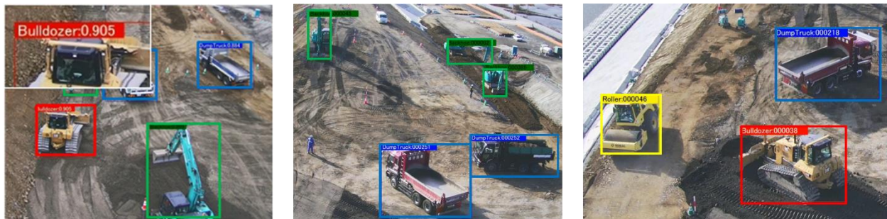
図-6 建機検出 AI での検出結果
