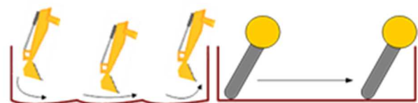
図-3 バックホウ（左）トレンチャー（右）の掘削イメージ
