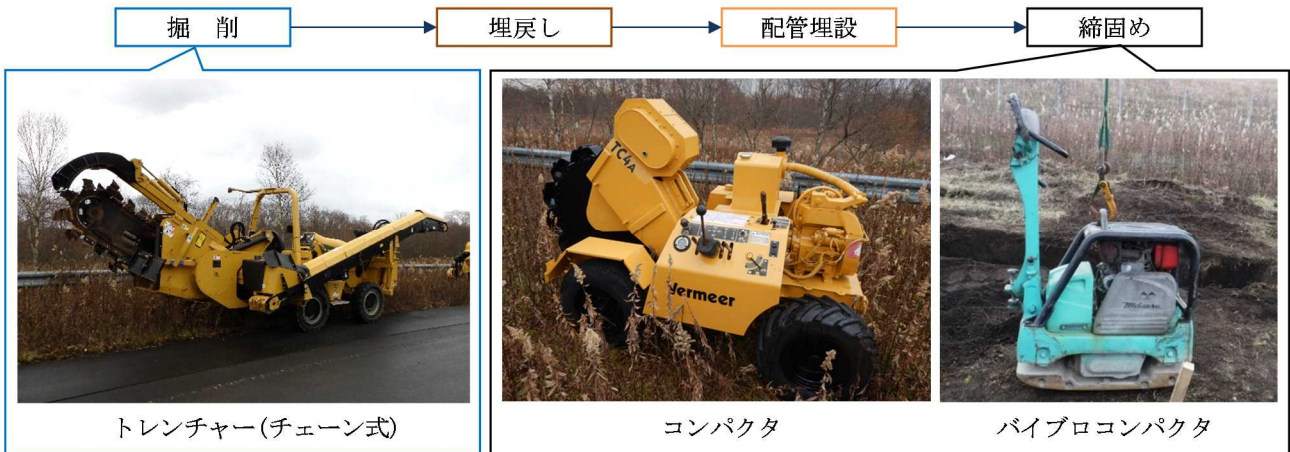
図-1 試験フロー及び使用機械
