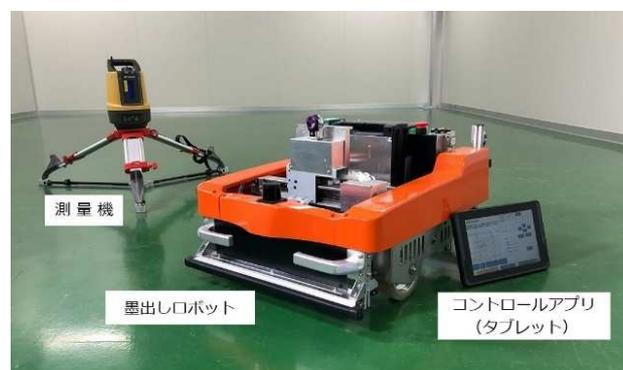
写真-1 自動式墨出しシステム構成
