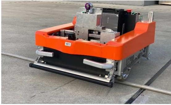
写真-4 段差乗り越え実験風景（電線 B）
