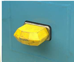
写真9 新ビット交換完了
