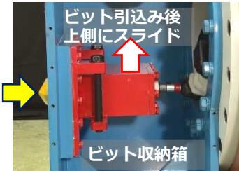
写真5 旧ビット引込み
