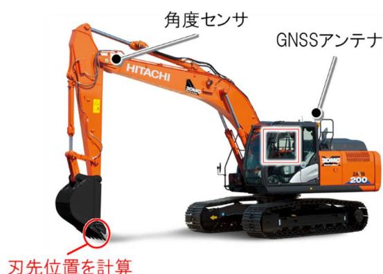
写真-1 ICT 建機全景
