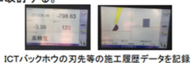
ICTバックホウの刃先等の施工履歴データを記録
