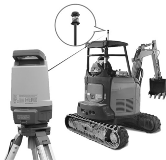
図-4 追尾用測量機とプリズム
