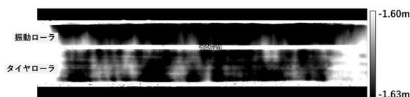
図-7 6回締固めた後のヒートマップ
