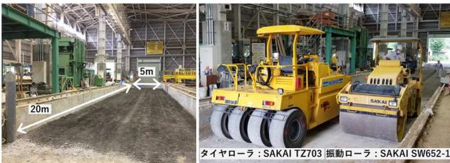
図-2 実験ピットと締固め機械
