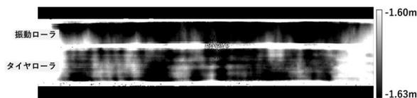
図-6 4回締固めた後のヒートマップ
