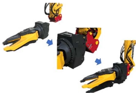
図-7 油圧オートカプラによる交換作業
