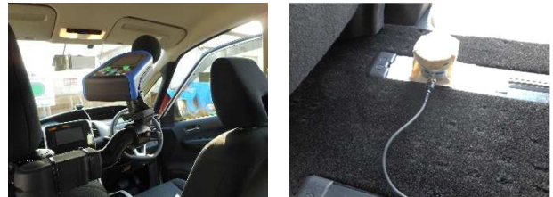
図-7 車内騒音(左)・車内振動(右)の測定状況
