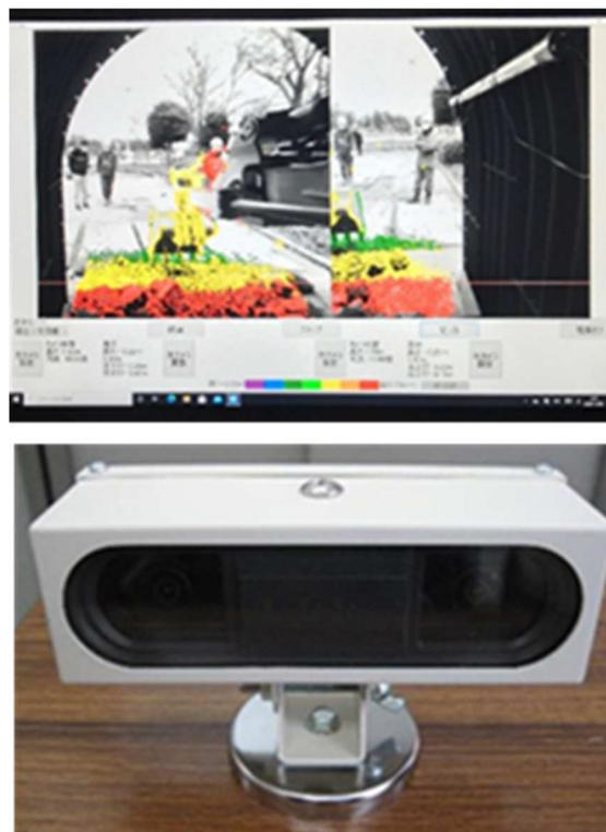
図-7 システム表示画面と距離計カメラ
