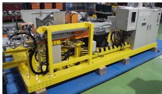
写真-1 遠隔爆薬装填装置
