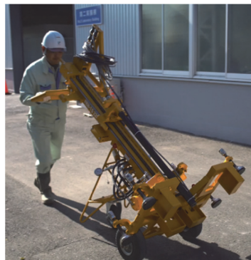
図-2 施工機的人力運搬状況
