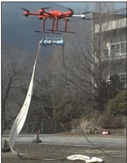
写真一3 ドローンによる運搬
