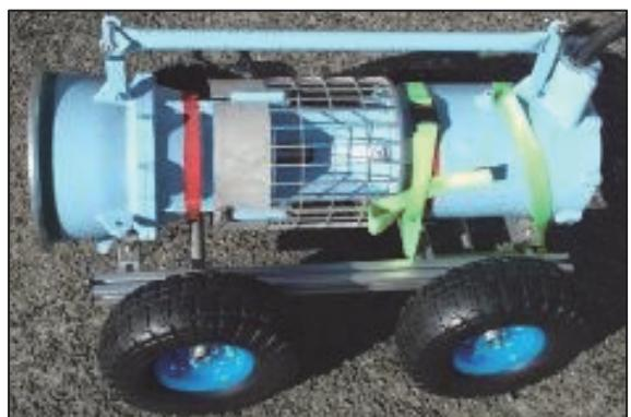
写真二　台車とポンプを固定
