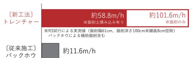
図-3 施工速度の比較（駐車帯部）
