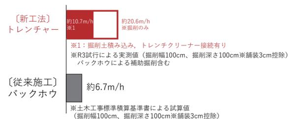
図-7 施工速度の比較（歩道部）
