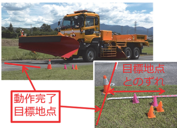
写真-4 自動制御動作精度の確認状況
