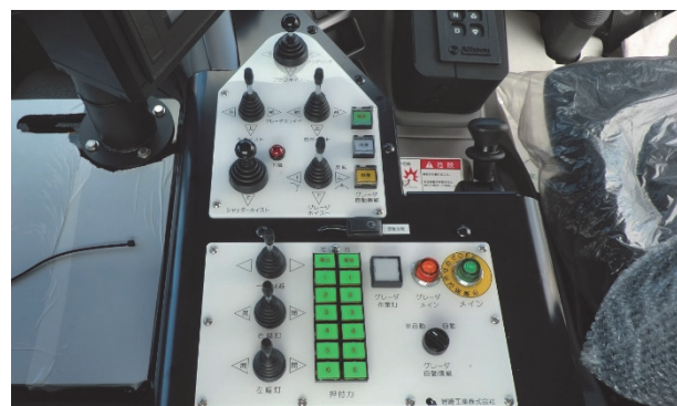
写真-1 作業装置の手動操作パネル
