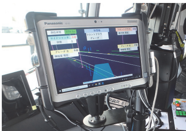
写真-2 自動制御装置
