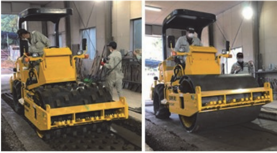
写真-1 締固め試験状況 (左: SVT-5t, 右: SVF-5T)
