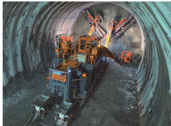
図-1 2ブームロックbolt打設専用機
