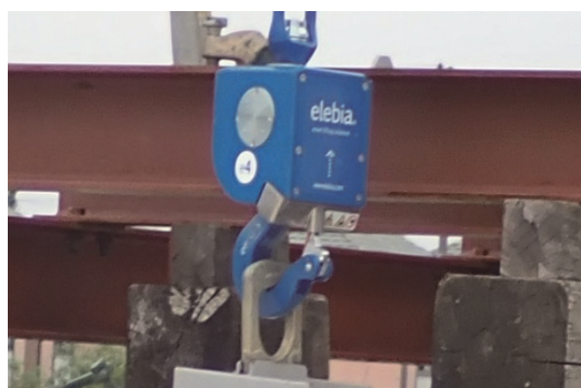
写真-8 自動開閉フック詳細
