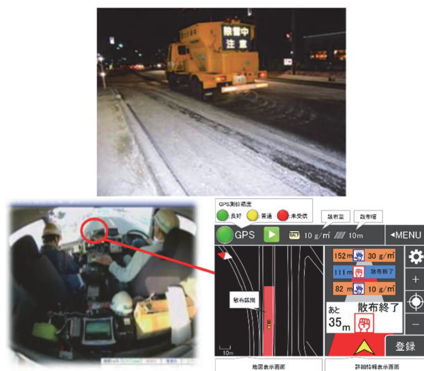
図-3 凍結防止剤散布車のガイダンス装置
