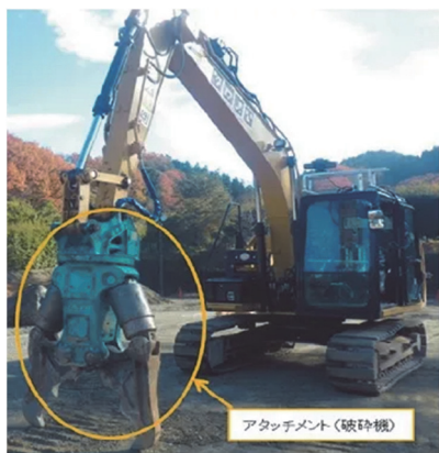
図-1 0 ロボ QS のアタッチメント例
