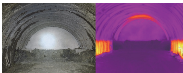
図-9 ハイブリッドカメラによるワイド画像(左)/熱赤外線画像(右)
