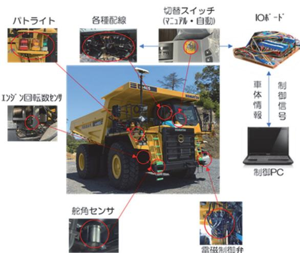
図-1 自動化リジッドダンプ及び改造箇所
