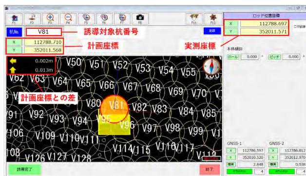
図 1 平面位置誘導システム表示例
