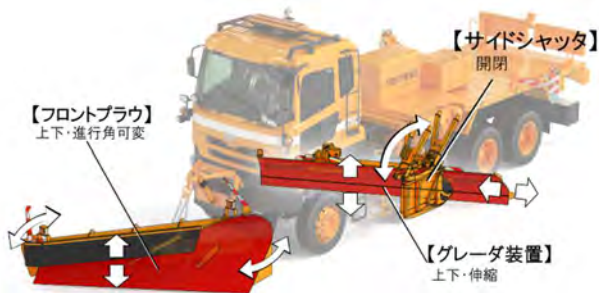
図-1 除雪トラック作業装置の概要
