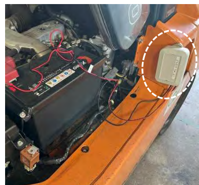
写真-1 IoT デバイス「どんだけ」 (建設機械稼働時間把握装置)
