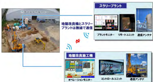
図1 自動打設システム概要
