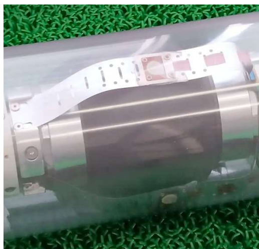
写真一 3 減肉測定可能なミミズ型ロボット
