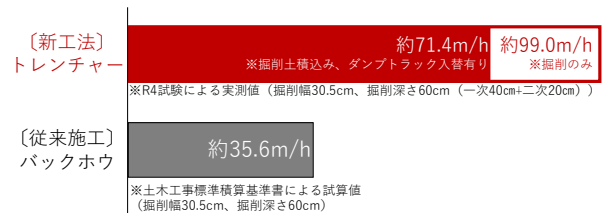
図-6 掘削速度の比較
