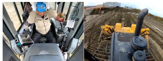
図-7 ブルドーザー操作時の生体測定 (内側・外側)
