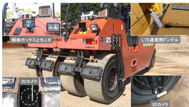
写真-5 システム機材配置状況
