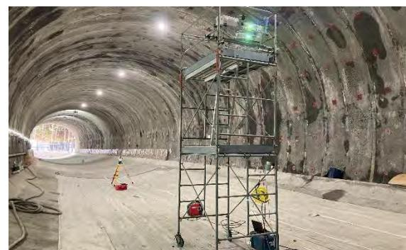
写真-2 3D 機器設置状況
