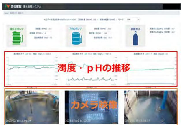
図-5 濁水処理設備遠隔監視用 Web ページ
