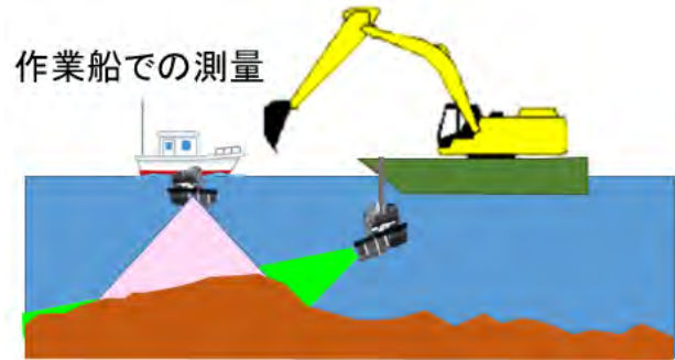
図-8 掘削前の測量
