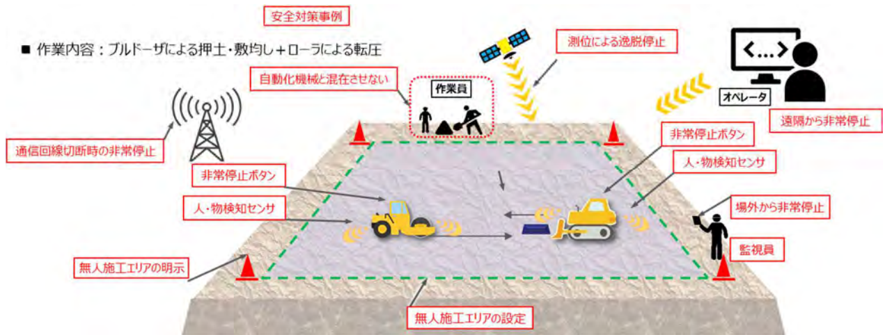
図－４ 無人施工エリア（緑点線の内側）の模式図と保護方策のイメージ
