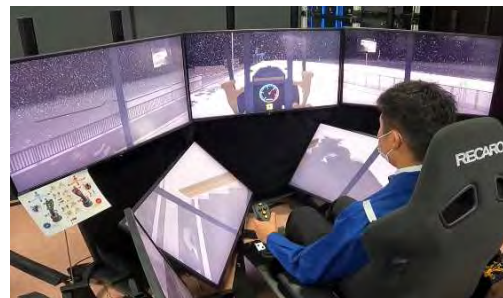
写真-2 除雪グレーダ操縦シミュレータ
