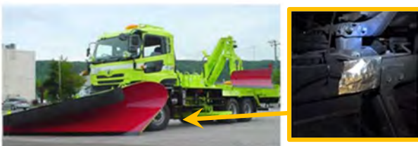
写真-3 加速度ピックアップ設置状況
