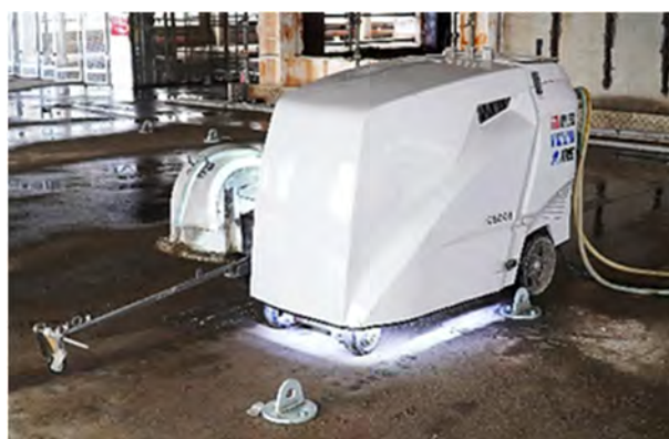
写真-2 スラブ斜め切断カッター
