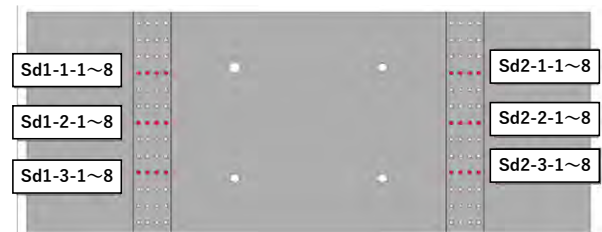
図-3 スタッドジベルのひずみゲージ貼付位置
