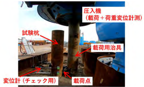
図-5 簡易荷重試験（水平）の実施状況
