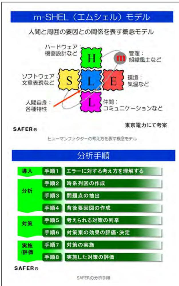
図-2 m-SHELモデルと分析手法<sup>3)</sup>
